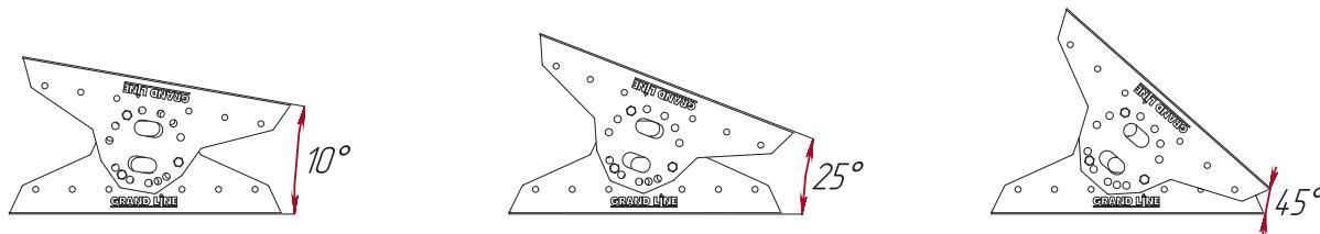
В месте установки элементов безопасности кровли рекомендуется применять сплошную обрешетку согласно СНиП II-26-76 "Кровли"
