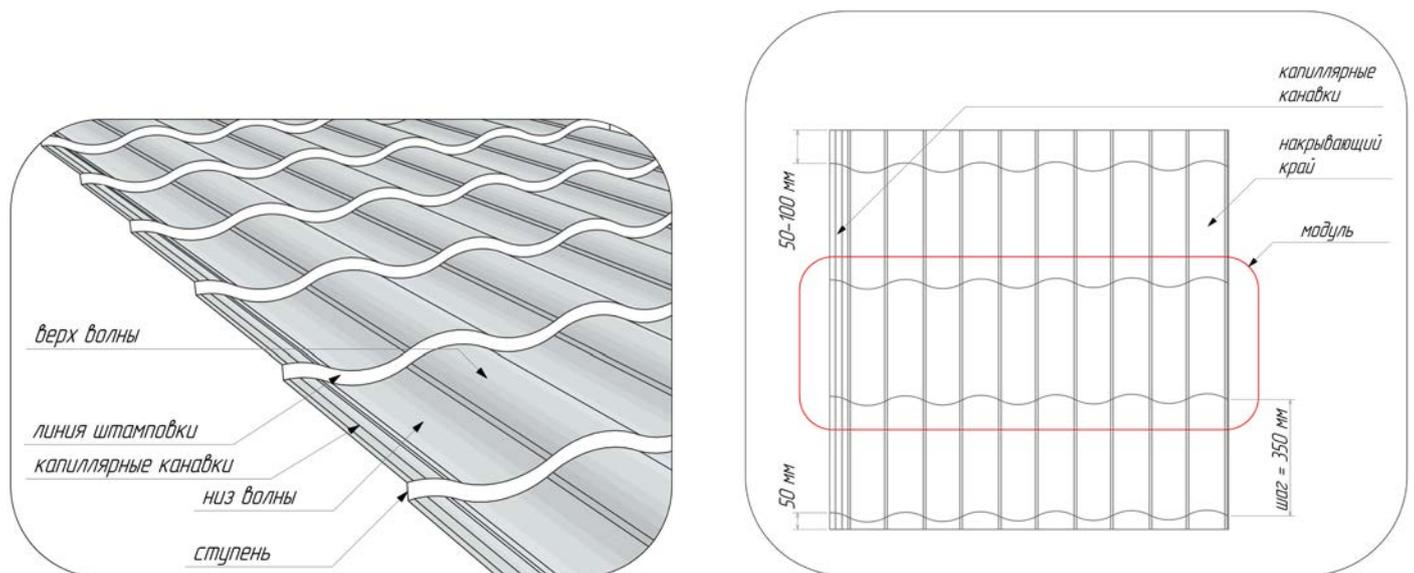
• Grand Line® производит несколько типов профилей металлочерепицы с различной формой волн и ступеней.
