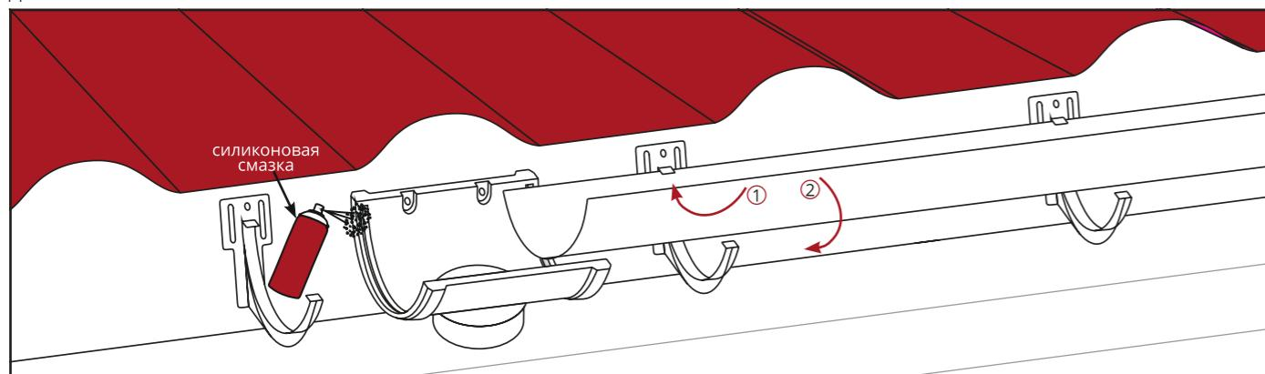
После того, как смонтированы все кронштейны и элементы, имеющие крепежные отверстия, установите желоба.
